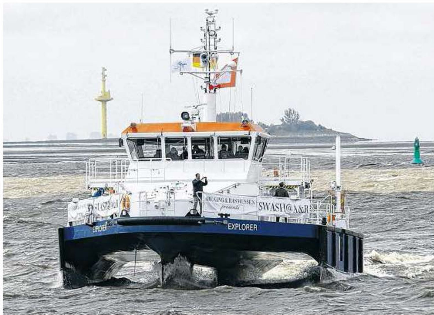
Die „Explorer“ bietet den Wellen deutlich weniger Angriffsfläche als bislang gekannte Versorgungsschiffe.
