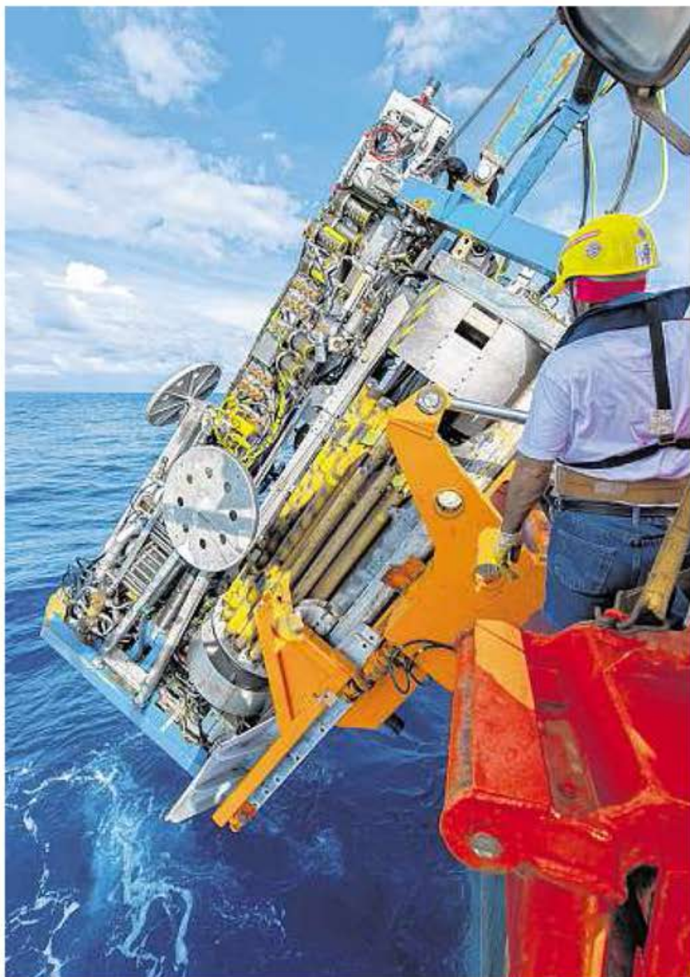
Das Foto zeigt das Vorgängermodell MeBo70 im Expeditionseinsatz. So ähnlich sieht auch der neue Bohrer aus. Allerdings kann der 700 Meter tiefer tauchen. FOTO: T. KLEIN / MARUM
