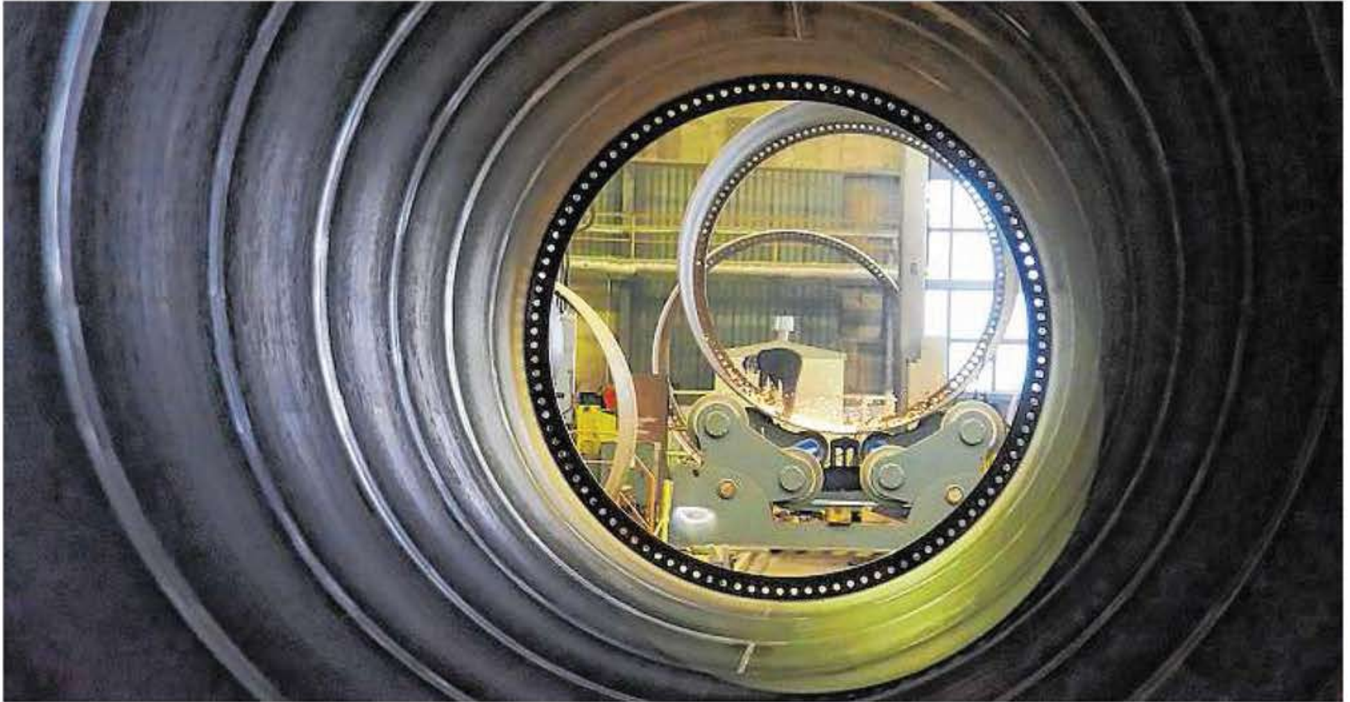
Auf der legendären Danziger Werft Stocznia Gdańk werden Turmsegmente für Windkraftanlagen mit einem Durchmesser von bis zu acht Metern gebaut.
