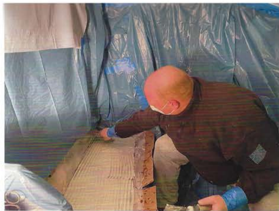
Nicht ohne meine Maske: Mit dem Zahnschachtel trägt Volker Kölling eine Mischung aus Harz, Härter und der Westsystem „High Density Filler 404“ auf eine Coosa-Compositplatte auf. (Fotos: Kölling)
