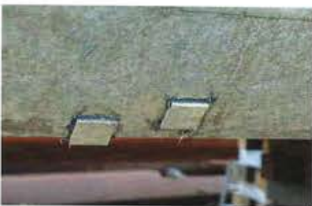
Zahlreiche Risse durchziehen das Unterwasserschiffs, Holzflücken decken die Bohrungen zur Begutachtung ab.
