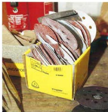
Vergiss das 80er Schleifpapier: Die alten Farblagen lassen sich nur mit 40er Schleifpapier und dem Metaboschleifer mit dem großen Hub bei voller Power wegschaffen. Die erste Fünfzigerkiste mit 40er-Schleifscheiben ist schnell aufgebracht. Auf einen 100er Schliff müssen wir es aber mindestens noch bringen, bevor wir an Grundierung und Spachtel überhaupt denken können. Das muss erst einmal verdaut werden.
